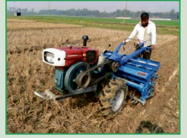
चित्र ४. दुई पाङ्ग्रे ट्रेक्टर (पावर टिलर) मा जडित सिड ड्रिल मेशिनबाट छरुवा धान रोप्दै
